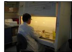
Bilde 3: God belysning i avtrekkskap/ sikkerhetsbenk
