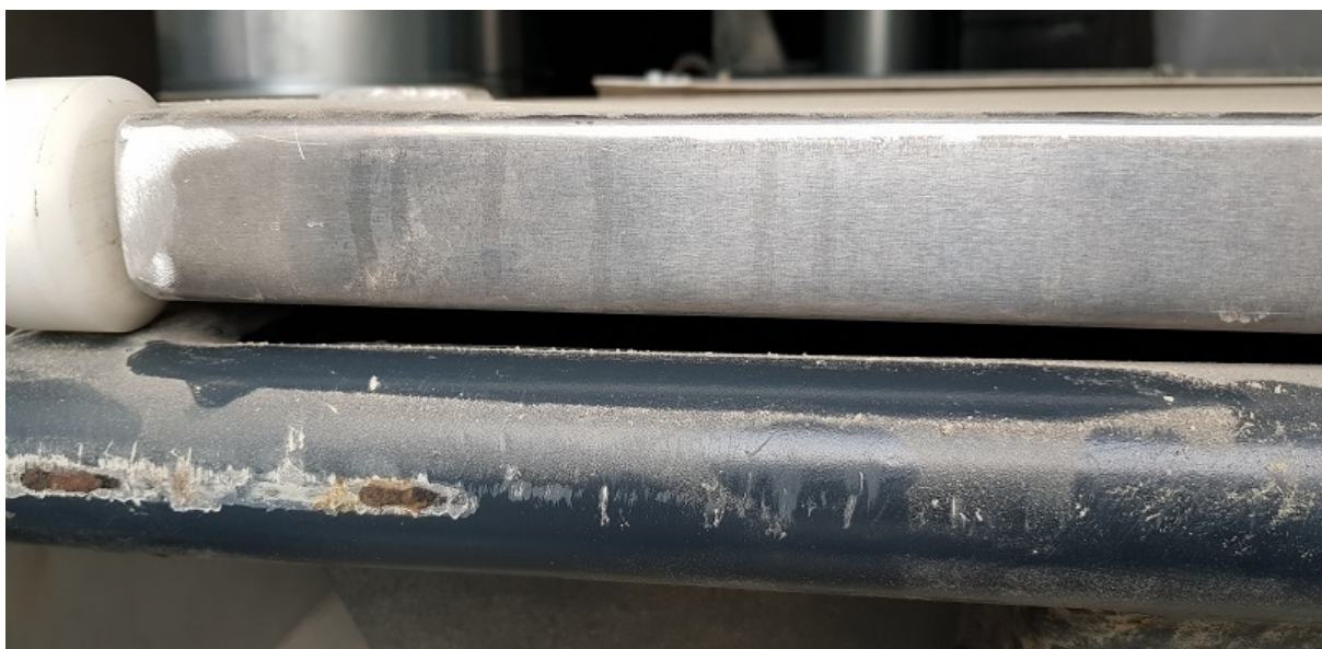
Figur 4. Dårlig tetting av lokk til beholder for spon/støv
