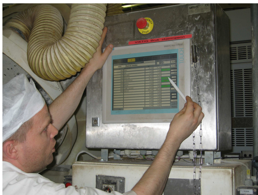
Fig. 6.4. Her "klikkes" mengden som skal fylles opp i eltekaret inn på skjermen, og så fylles karet automatisk.
