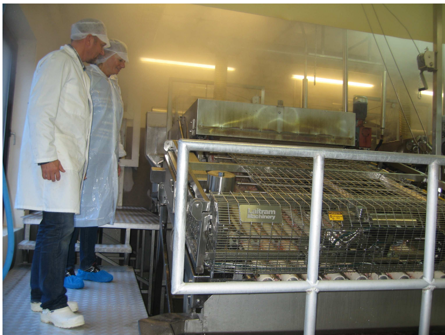
Fig.7.7. Dette er en rekepillemaskin. Rekene kokes først, og sendes deretter gjennom maskinen der skallet spyles av. Manuell rekepilling gir risiko for allergi, og maskinen er et godt forebyggende tiltak. Det damper mye fra rekekokingen bak maskinen, så god ventilasjon er viktig slike steder – samt at få arbeidstakere oppholder seg her.
