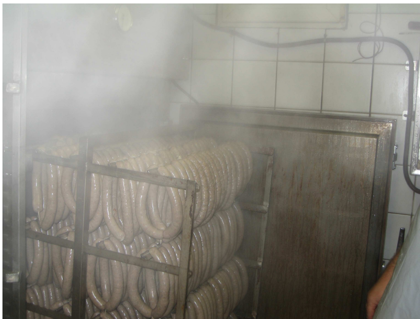
Fig. 6.10. Her ser vi tydelig dampen som velter ut når pølsene tas ut av et skap etter at de er blitt dampkokt. Her burde det ha vært et avtrekk slik at de ansatte ikke puster inn denne dampen. Pølsene kan inneholde forskjellige krydder som lett kan gi allergier.
