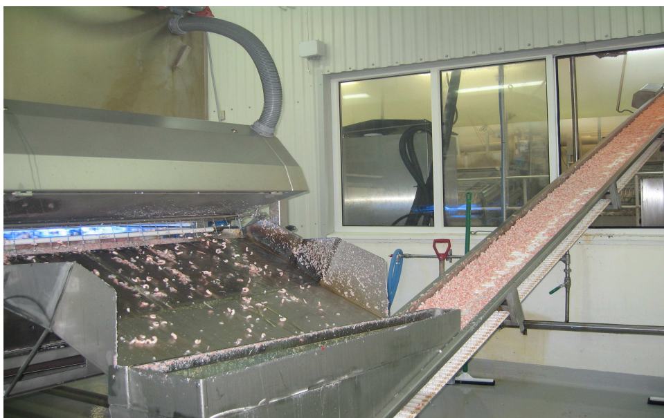
Fig.7.8. Her sorteres rekene ved bruk av lys, slik at man sikrer seg at alt skall er vekk. Dette er også en maskin som forebygger allergi, ved at det ikke er nødvendig for arbeidstakerne å være i kontakt med rekene her.
