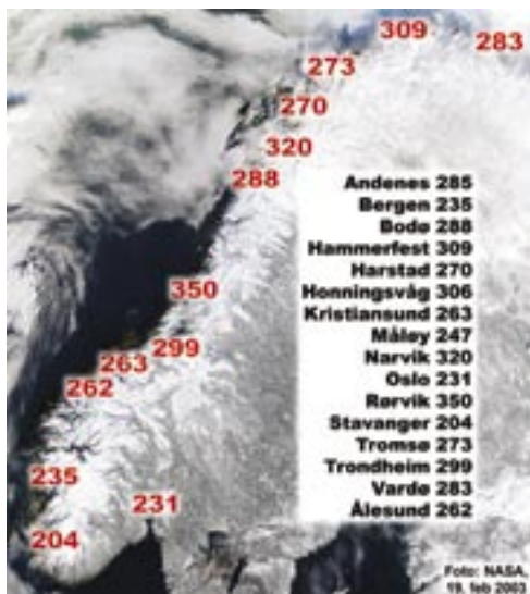
Figur 3. Mulig stormflo (i cm) i år 2100 relativt kote null (NN1954, se http://vannstand.statkart.no/main.php ). Høydene er framkommet med å ta høyeste stormflo som er observert fram til i dag, legge til 80 cm fra scenario A2 (se figur 1), pluss 10 cm høyere havnivå hos oss, pluss 10 cm for økt stormaktivitet, minus landheving fra tabell 1.
