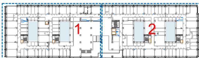
Figur 76 Systemet for elektrisitet er delt i to.
