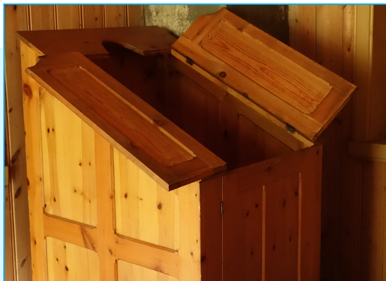
Dampstol i nøstet. Foto: EIA
