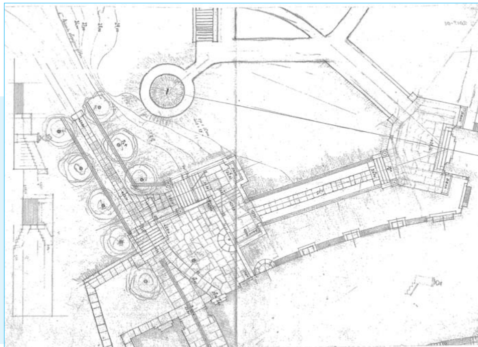
Originaltegning: Detaljer trappeløp og plass med fontene (ikke datert). Sirkulært bed er plassert sentralaksen mellom de to adkomstvegene. Beleggsplan i stor grad gjennomført.
