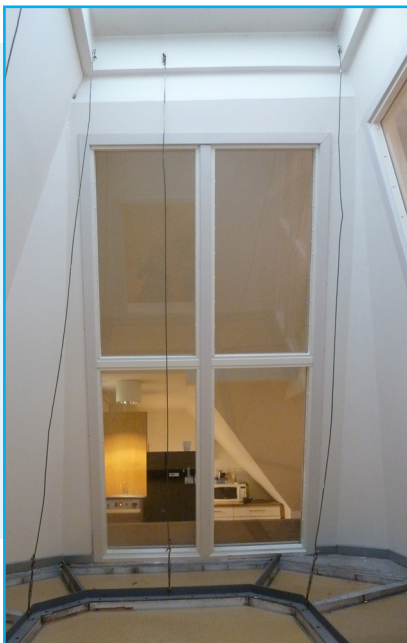
Rom 17.300 rom over overlys, med strenger som holder overlyset på plass. Foto: EIA
